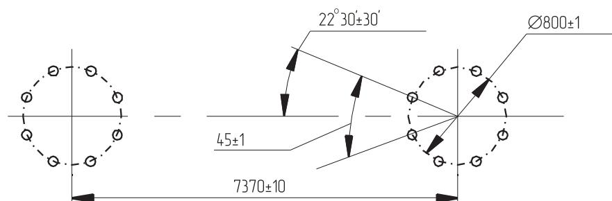
**Расположение отверстий контактных выводов**
